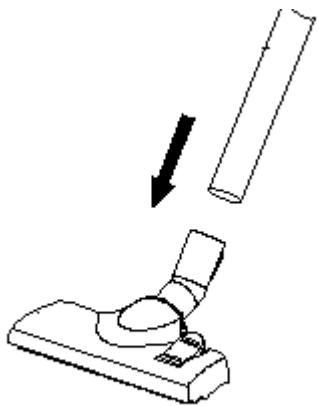
Подготовка насадки для чистки ковров, плиточных, деревянных покрытий:
