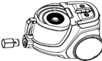
Поверните его примерно на 30 градусов по часовой стрелке до фиксации.
